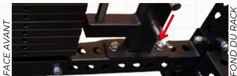
**Positionnement du montant de la smith machine au 3e trou au départ du fond du rack.**
