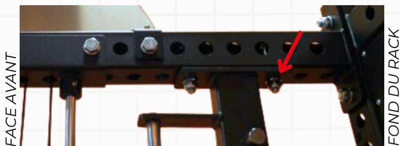
**Positionnement du montant de la smith machine au 3e trou au départ du fond du rack.**
